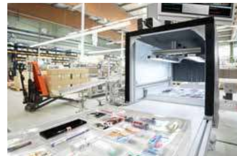
Modernste Technik wie diese vollautomatische Kameraprüfung steigert Produkt- und Prozesssicherheit.
